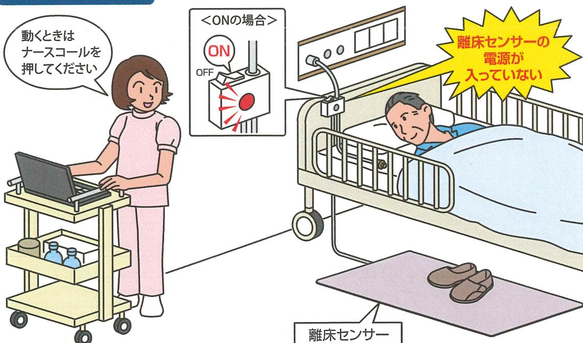
◆離床センサーには、マットセンサー、ベッドセンサー、クリップセンサー、赤外線センサーなどがあります。
